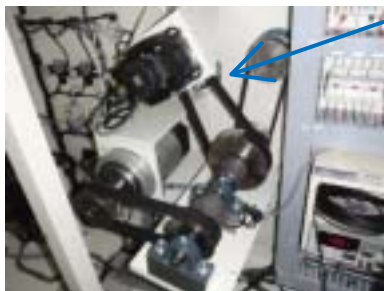
モータ駆動部 (ACサーボ) (トルク制御/速度制御を任意に切替可能)
