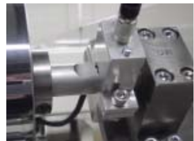
センサロール搭載部(拡大) (配線接続モジュール取付)
