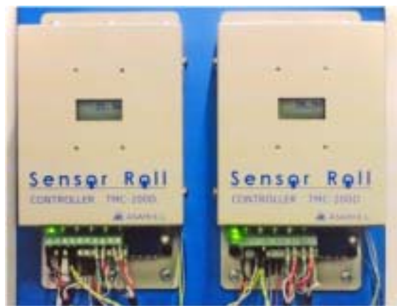
図10. テンションコントローラ (TMC-200D) (SIZE : 200mm × 107mm × 39.6mm)
