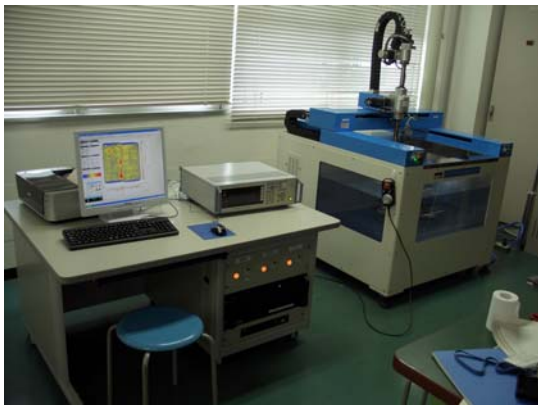
写真 1 超音波探傷映像化装置 日本クラウトクレマ株式会社製 (SDS-Win 6500R)
