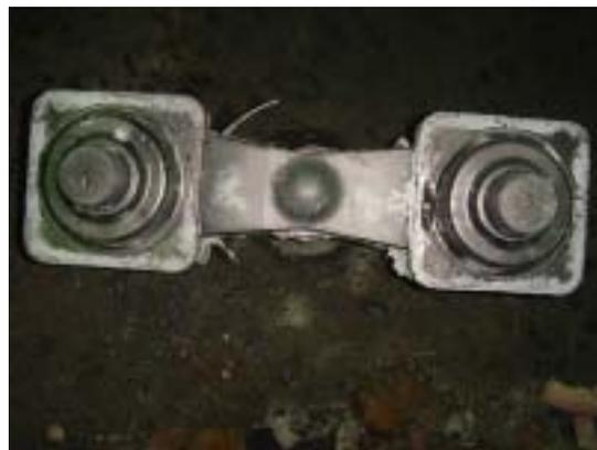
図 - 2 鑄造した状態のキャップ
