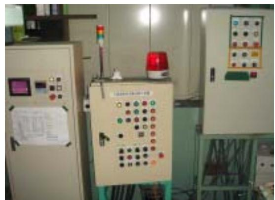
図 1 加圧装置付き鑄造機と全体制御盤
