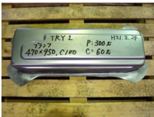
図4 Battery Boxの一体成形
