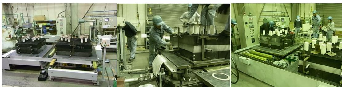
a) 低圧鋳造炉で注湯      b) 注湯直後に湯口遮断      c) 注湯後の鋳物冷却工程
