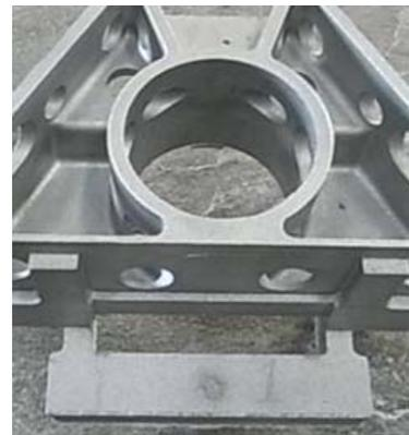
図 1 4 モデル鋳物 A の試作結果
