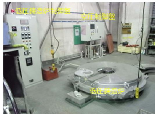
図11 低圧鋳造装置の据付、調整、運転準備完了の状況
