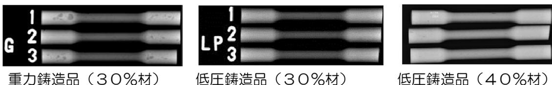
図18 アルミ基複合材試片のX線透過写真
