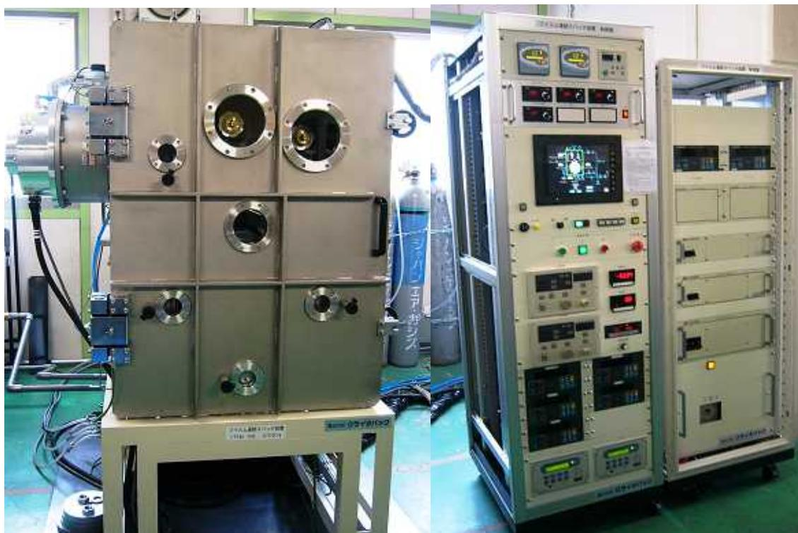
写真 1 - 3 フィルム連続スパッタ装置の外観
