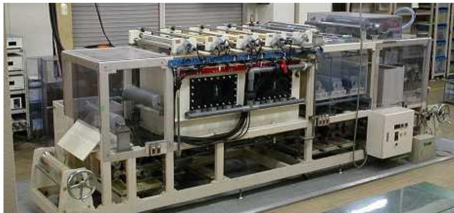
写真1-4. RTR硫酸銅めっきテストライン
