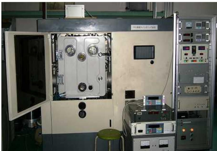
写真1-1 小型実験用スパッタ装置
