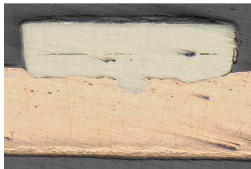
図 2-5-5 Ni-Cu 接合の断面マクロ
