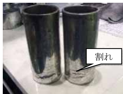
図 2-2-15 鍛造試作品 (AC2B+SiC5%材)
