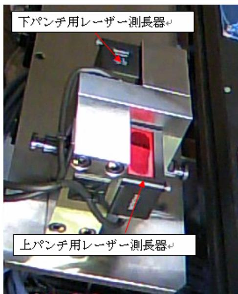
図8. 温度補正軸 センサー部
