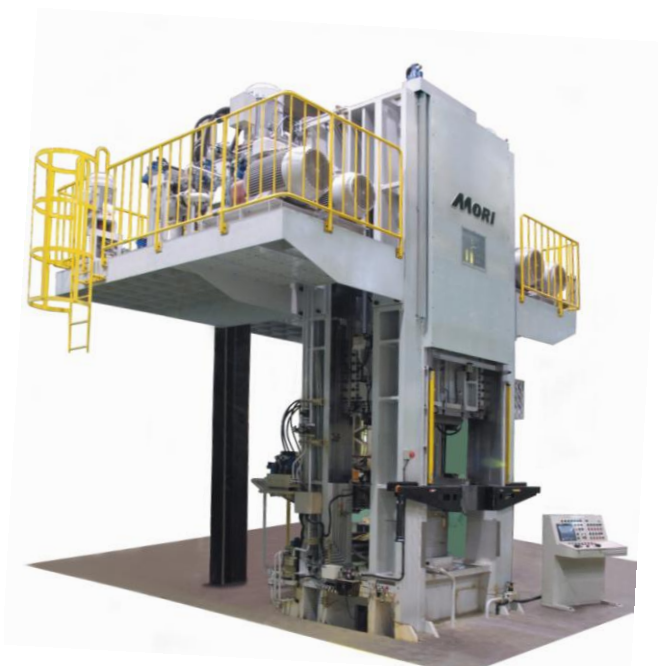
写真 2-1 6 軸サーボ制御 10,000kN 試験機の概観
