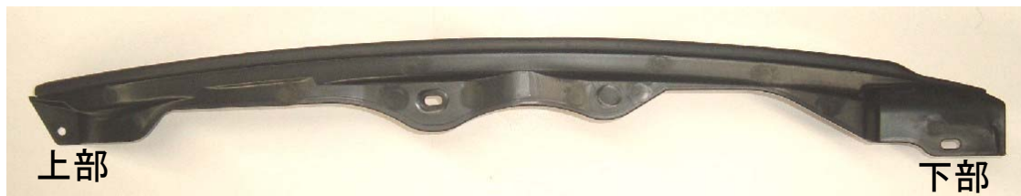
図3 収縮・接合テスト型から得られた成形品
