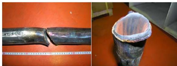
図 39 曲げ試験後のサンプル外観(両側予熱)
