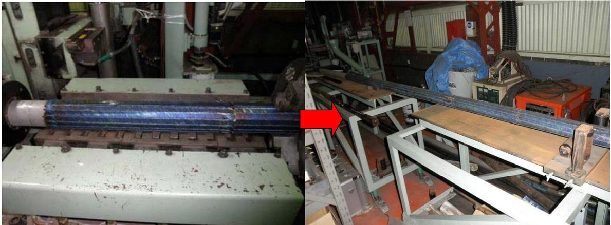
図7 ボイラー管への長尺肉盛
