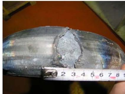
図 38 曲げ試験後のサンプル外観
