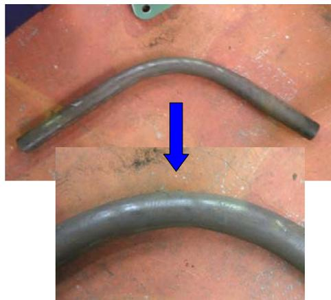
図 50 パイプベンダーの曲げ加工試験
