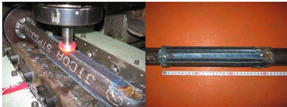
図8 小径管肉盛試験状況及び全周肉盛管外観写真
