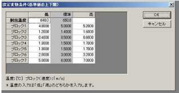
図 2-2-7 繰返しシミュレーションのための水準の決定
