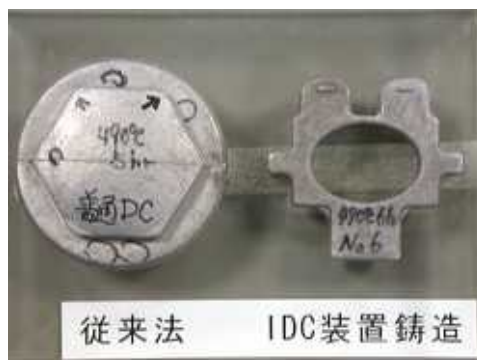
図 2-2-16 490 の T 6 処理後の外観 (黒い印はふくれ部分)
