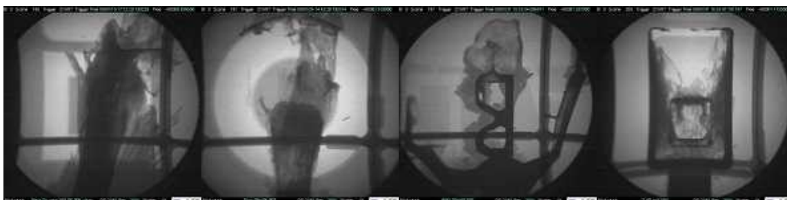
図2-2-2 左から「矩形」「円盤状」「ABO」「ボックス」の型に流入する溶湯の様子
