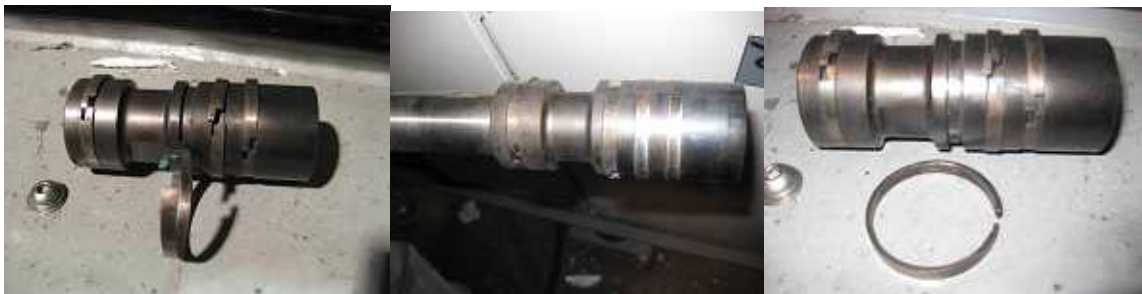
写真 2-1-7 チップ(左) リング(中央) 及び 変形したピストンリング(右)
