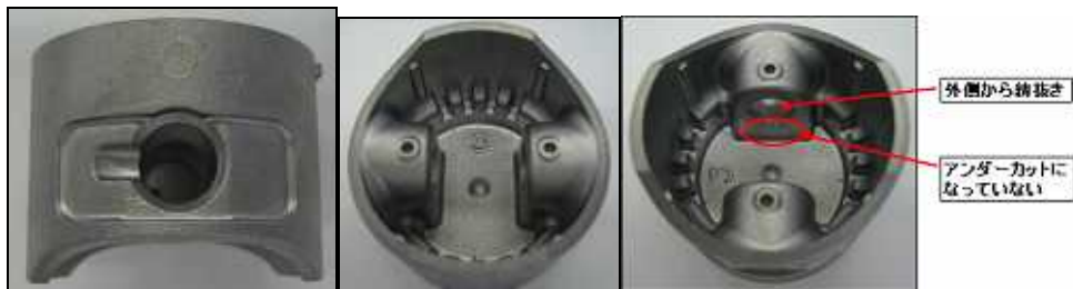
図 2-3-1 モデルとした、現行量産されているアルミダイカストピストン
