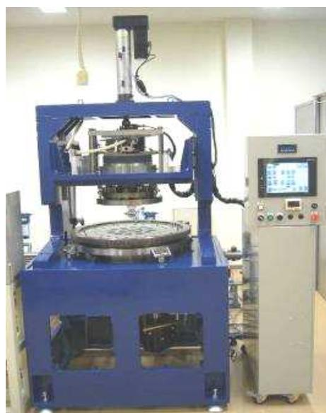
図 2 精密研磨装置部全体図
