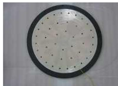
図3定盤一体型ポリシングパッド完成写真
