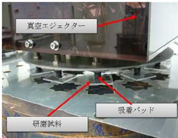
図 8 試料吸着図 (粗研磨装置部)
