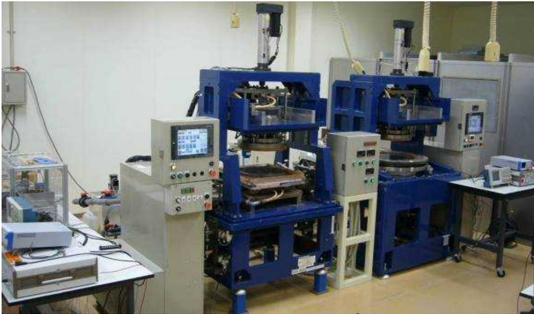
図 1 改造後の次世代情報家電向け研磨システム全
