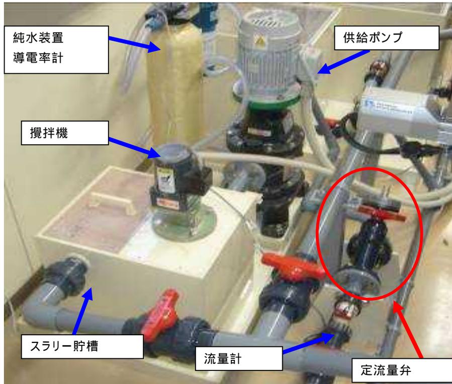
図 1 粗研磨用スラリー精密投与装置
