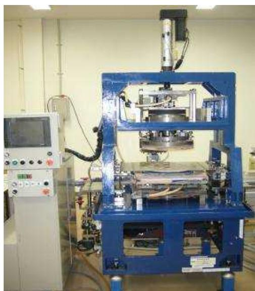
図 1 粗研磨装置部全体図
