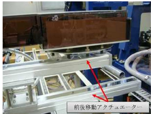
図 9 粗研磨装置外 試料搬出図
