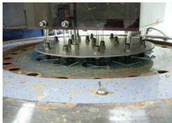
図 11 試料配置図 (精密研磨装置部)
