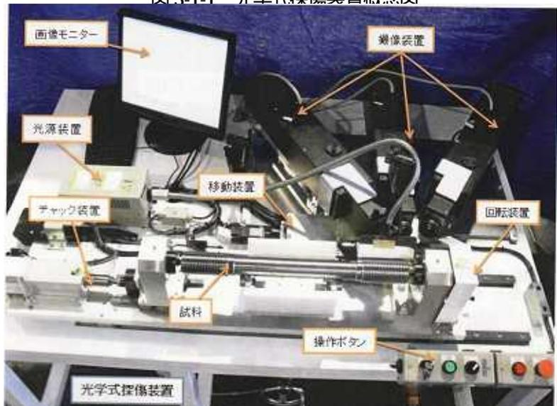
図3-1-2 光学式探傷装置
