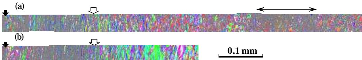
図2-1-17 微細組織におよぼすダイス送り速度の影響
