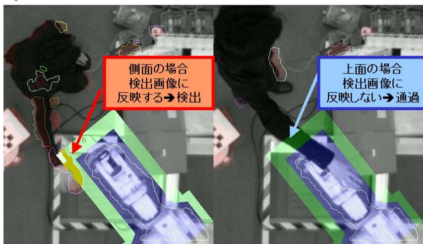
図 4-7 作業員の腕とロボットの位置関係で危険性を判断する
