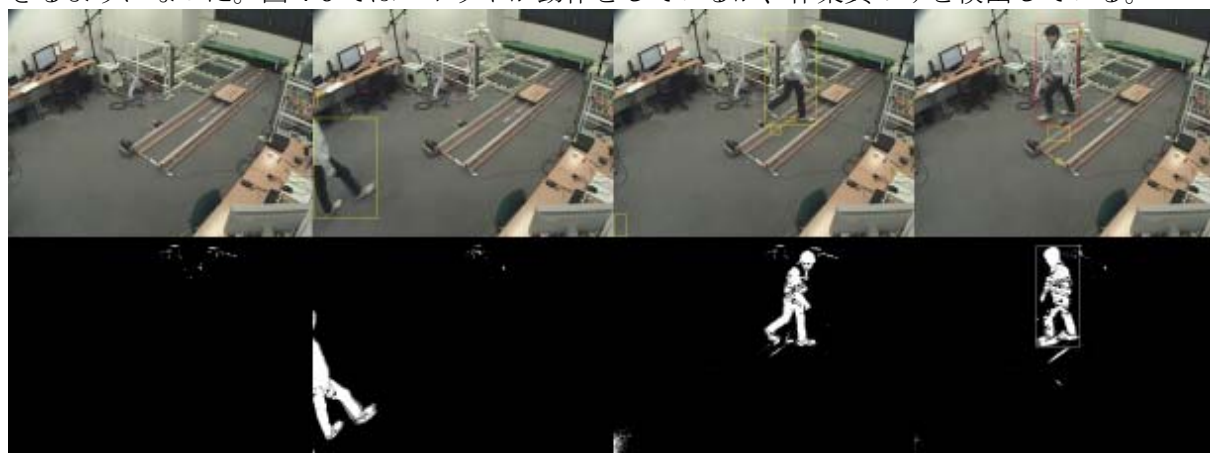
図 4-6 ロボットが動作している状況で作業員のみを検出する
