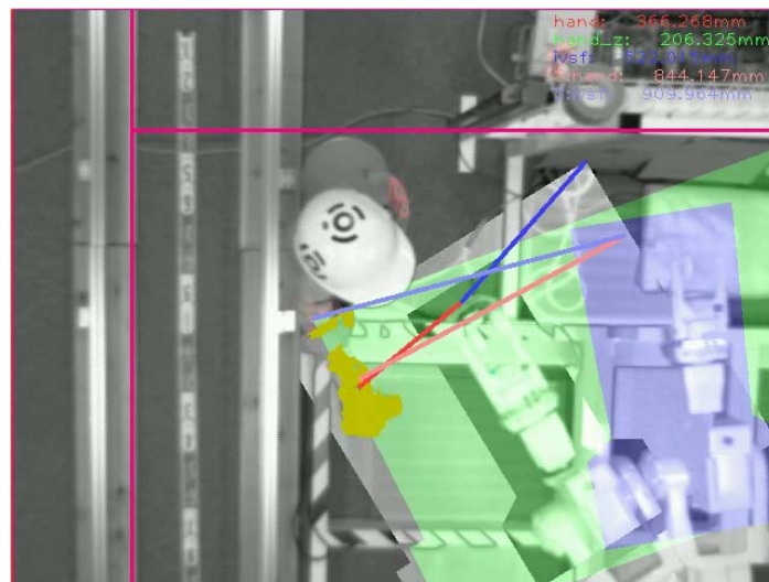
図 6-8 衝突判定試験の一例。図中赤線が本試験の測定距離。
