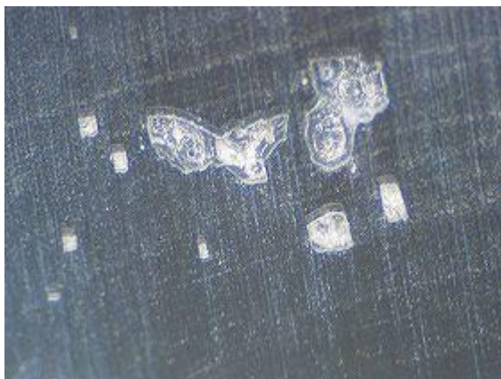
図3. 2-1 素材異常核・割れ状態及び外周部異常核除去
