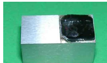
図 4.1-1 単結晶ダイヤモンドの接合状態
