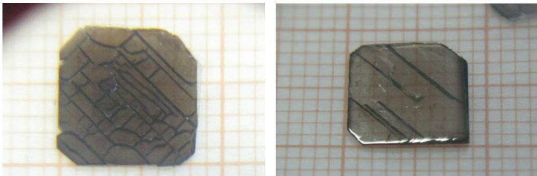
図2. 3. 1 残留応力による基板の割れ 左：合成部分（厚さ約 200 μ m）成長面、右：種基板剥離面
