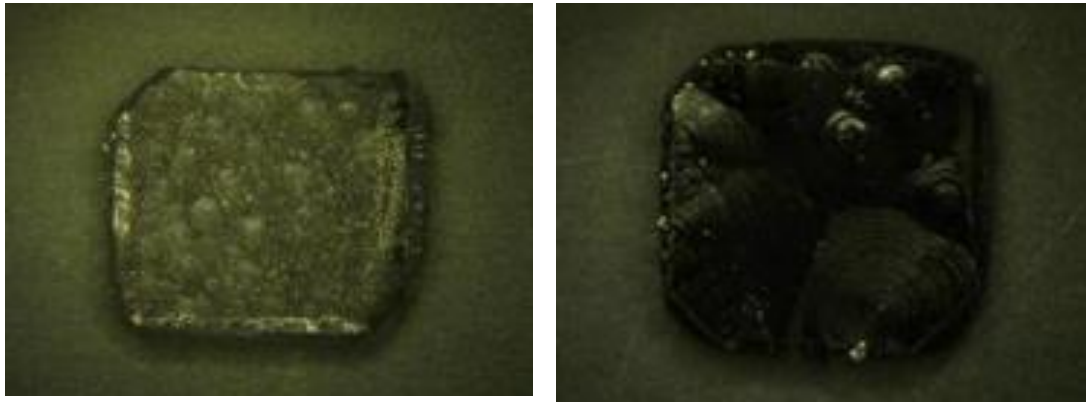
図 2. 1. 2 電極水冷機構改良前後の 6 ミリダイヤモンドの合成表面の比較 左：改造前 右：改造後
