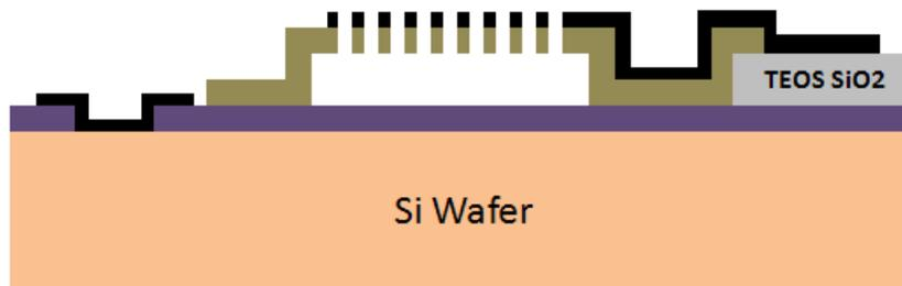
図 2-3-5 TEOS SiO<sub>2</sub> 薄膜を一部変更したセンサデバイス構造断面図
