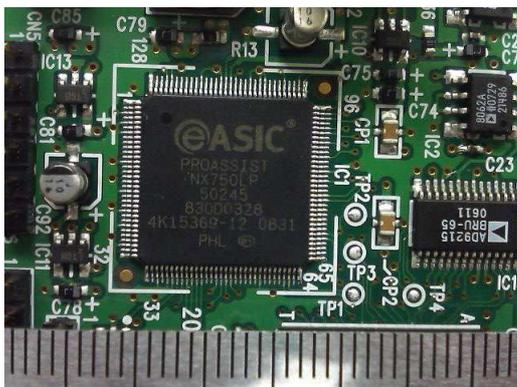
写真 6-4-1 ASIC チップの外観
