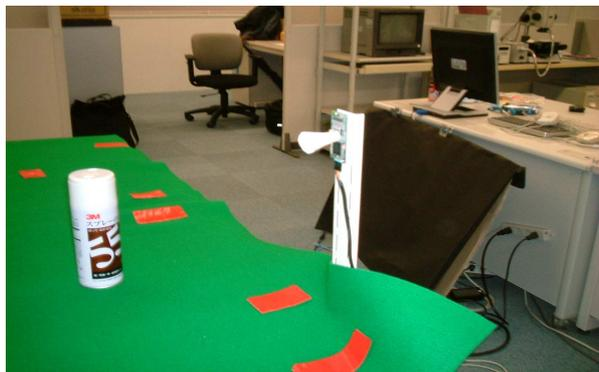
図 7-3-3 二次元センサ 1 台を設置した実施例
