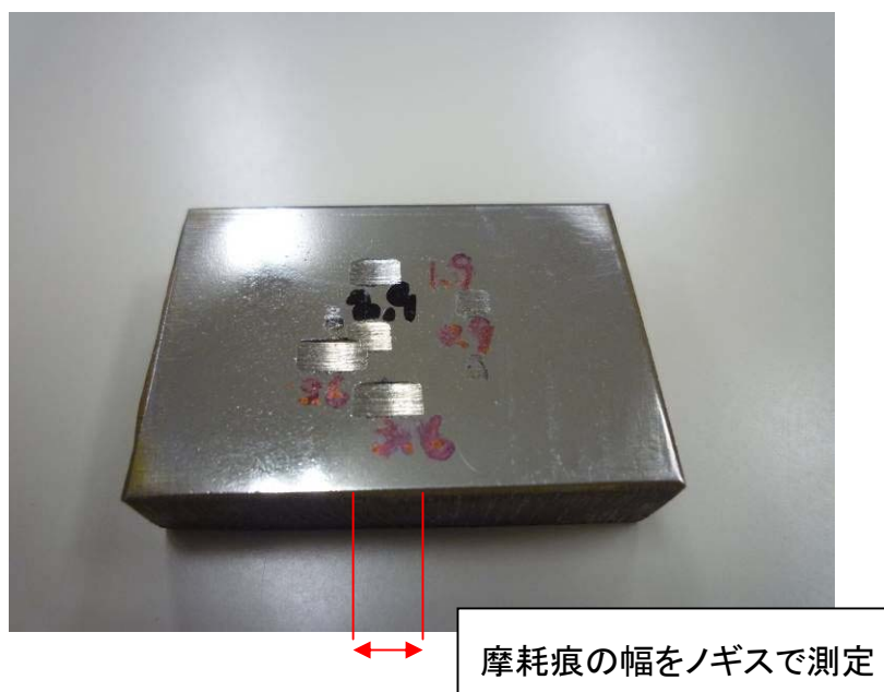
図 3 - 5 摩擦摩耗試験後の試料の摩耗
