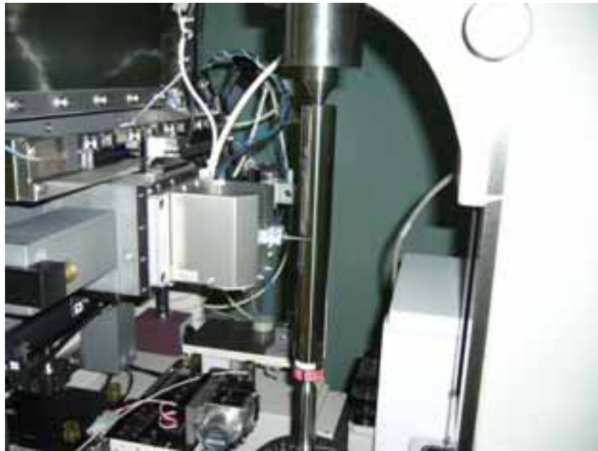
図7 Z軸方向校正測定の外観
