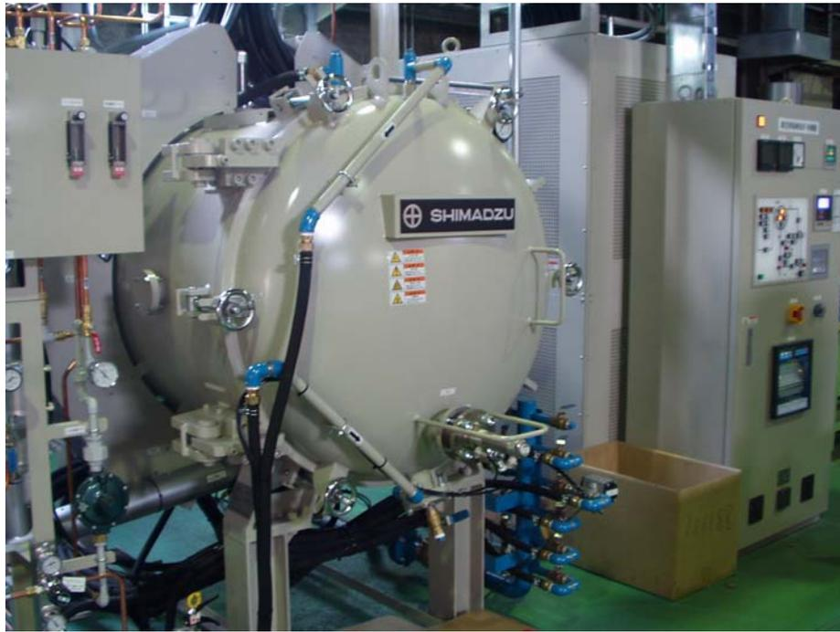
图 2 - 1 0 真空脱脂烧结炉
