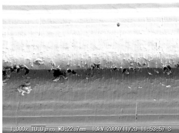
図 4 白コート PET フィルム基材連続打抜き試験後の外観比較写真
