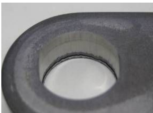
図 2-1-4 多回プレスモーシヨンの試験片観察例(S45C)
