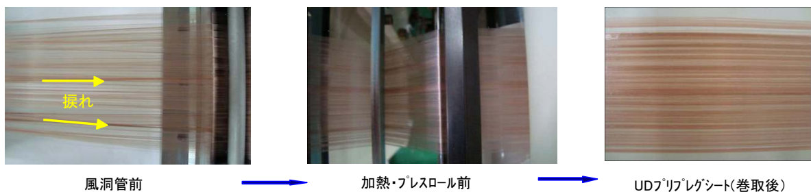
図 3-5 開織装置での開織シート割れおよび単系開織粗密斑の状況
