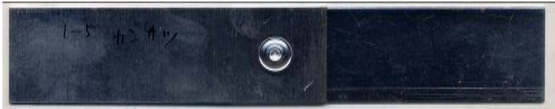
図 5-3 接合体表面 (AZ31/A1070 1000rpm-5000N-7s-TG7A)
