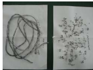
クーラントの条件による切屑状況 (左) 通常クーラント (7 kgf/cm 2 ) (右) 高圧クーラント (70 kgf/cm 2 ) 切削条件：切削速度 50 m/min 切込量 1.0 mm 送り量 0.1 mm/rev
