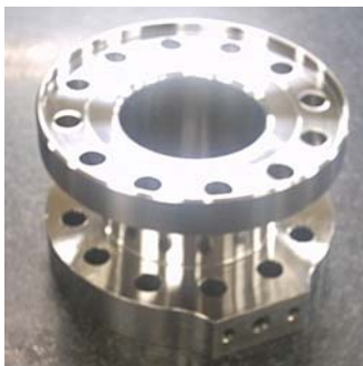
図 5-1 ロケットエンジン部品 (シリンダー)
