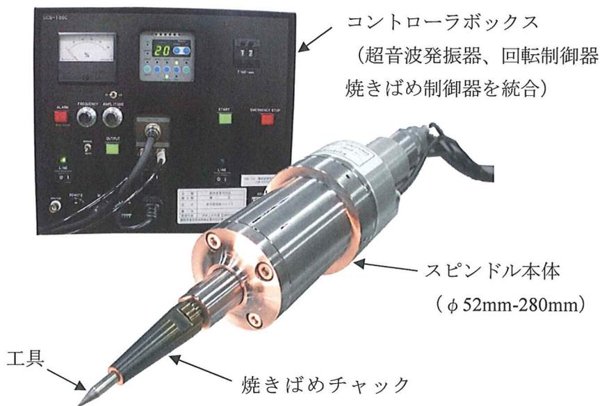
図 2-1 実用型の玉軸受型超音波マイクロスピンドル UBS11 の外観
