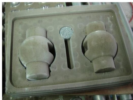
図5 凍結中子を凍結鋳型にセット
