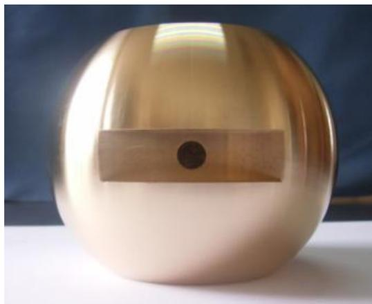
図6 60mmボールバルブの外観(機械加工後)
