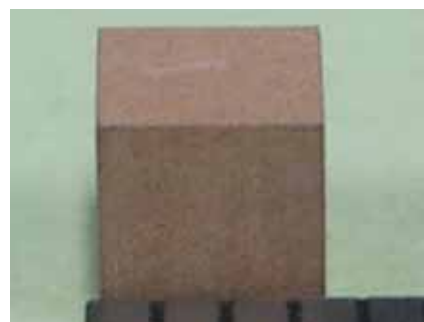
図11 TG-DTA 測定後の MA 試料の外観
