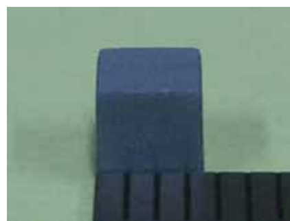
図9 TG-DTA 測定後の WC-37vol%Co
