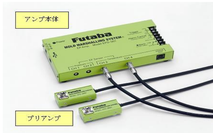
図1-5 温度計測システム
