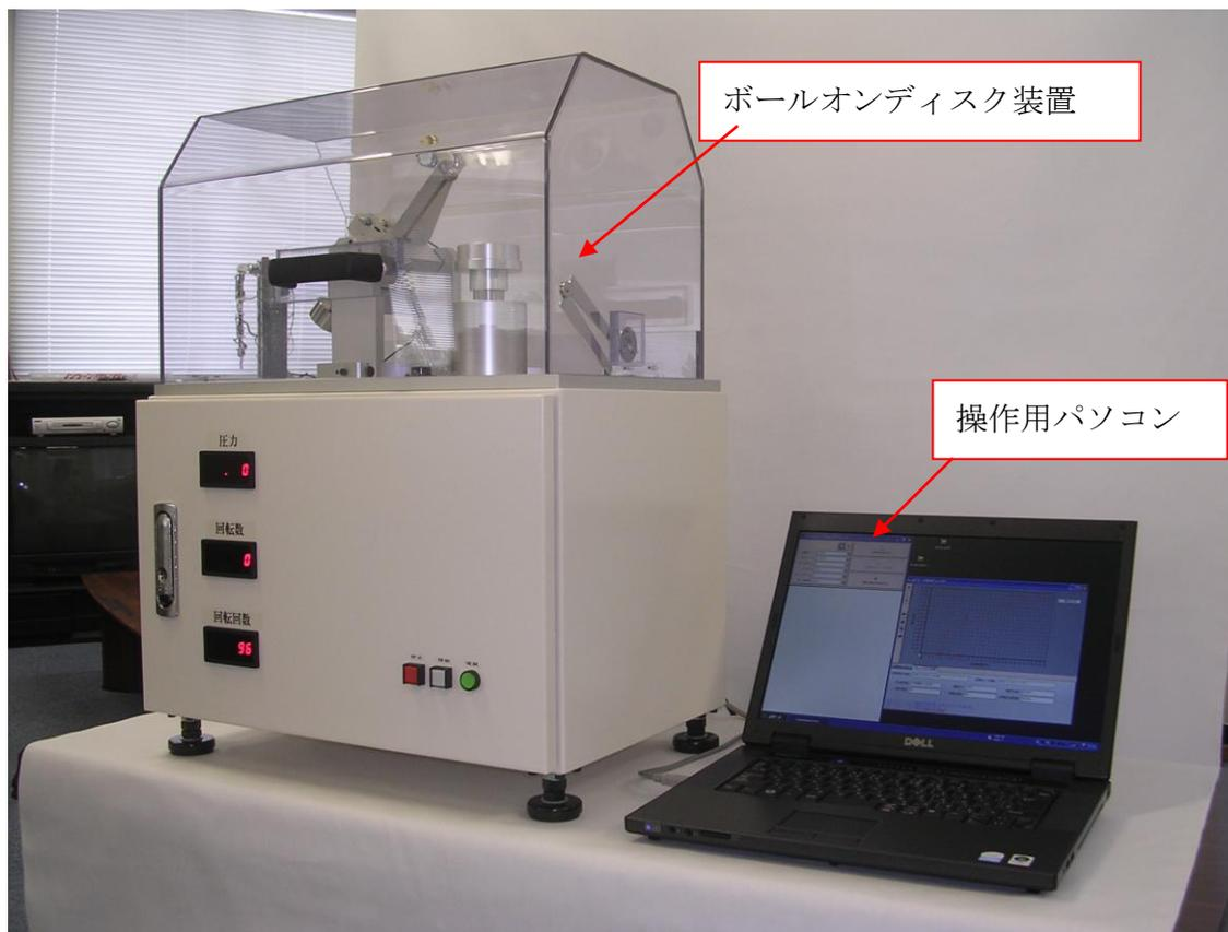
図 3-6 ボールオンディスク試験装置
