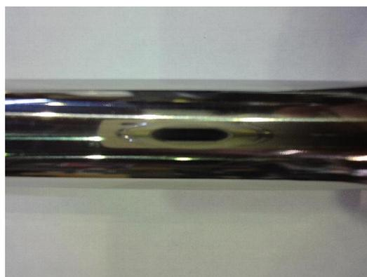
図 6-7 ステンレス製シャフト（被摺動
