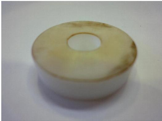
図 6-1 テフロン試料+表面処理
