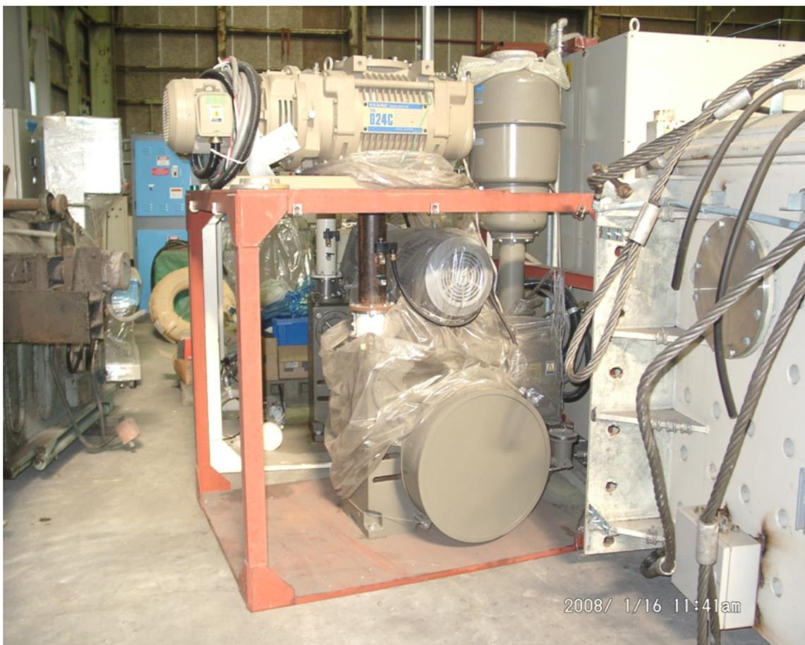
写真 1 真空溶解炉用真空ポンプ
