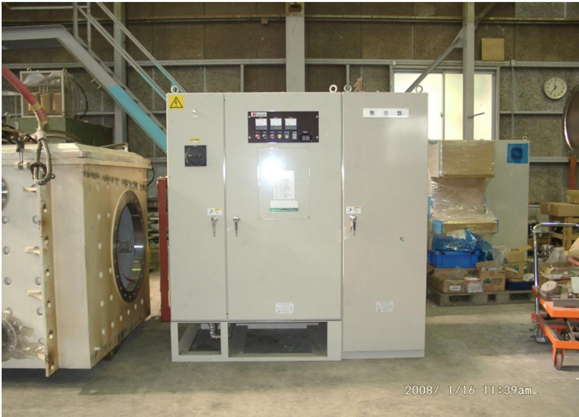
写真 3 溶解炉制御盤
