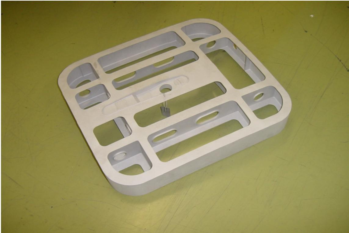
写真5 メインフレーム試作品（材質：A357合金）
