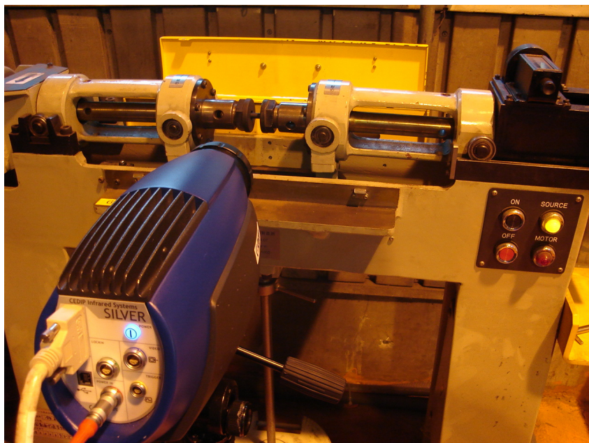
図 2-3-2 疲労限界測定状況（奥：回転曲げ疲労試験機、手前：赤外線カメラ）
