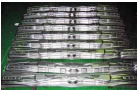
図 18 成形された 50 枚のセンターピラー (1475x320xH76.8mm、板厚 2.3mm、590MPa)
