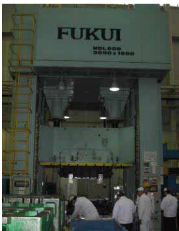
図 23 使用したプレス機(福井 8000kN クランクプレス) 図 24 使用した金型 (ひけない合金 FCD-1S)
