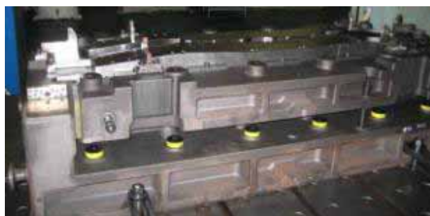
図 23 使用したプレス機(福井 8000kN クランクプレス) 図 24 使用した金型 (ひけない合金 FCD-1S)
