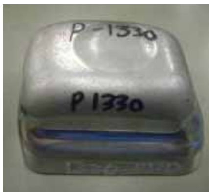
(a) パッチ (440MPa ハイテン鋼板) (70x60x40, t2.3 mm) 1330 個をカジリ無しで成形
