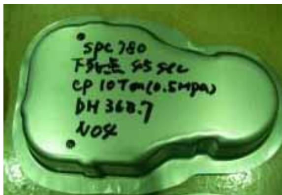
(b) ロッカー (780MPa ハイテン鋼板) (165x260x40, t1.2mm ) 140 個をカジリ無しで成形
