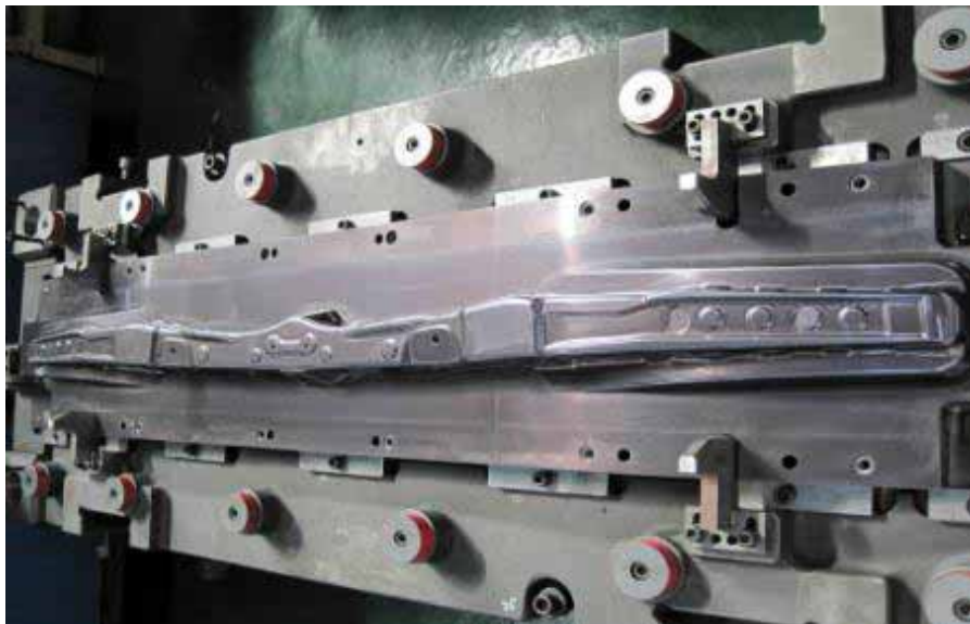
図 17 完成された金型(下型)(センターピラー成形用の金型)
