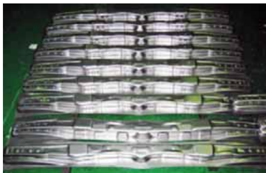
図 25 成形された 50 枚のセンターピラー (1475x320xH76.8mm、板厚 2.3mm、590MPa)
