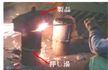
図8 金型鋳物の製作における押し湯施工と除去の様子(材質：合金FCD-I)
