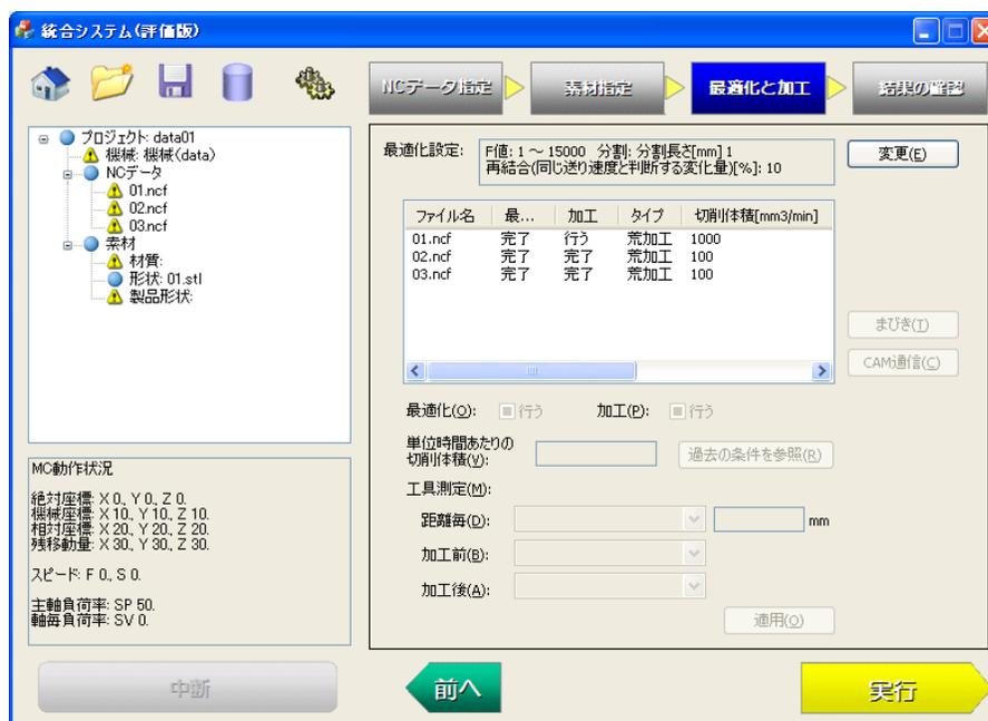
素材設定までが完了すると、上図の最適化と加工ダイアログ表示となり、NC データ毎にシステムに行わせる処理を個別に指定を行い、「実行」ボタンにより処理を行わせることができる。
