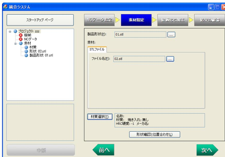
NC データの設定が終わり、「次へ」ボタンを押すと上図のように素材形状・素材材質及び製品形状の設定ダイアログに移行する。このダイアログでは製品形状及び素材形状として既存の STL ファイルを指定して認識させる事ができる。特に素材形状指定はシミュレーション処理を行う際に必須の情報となる。
