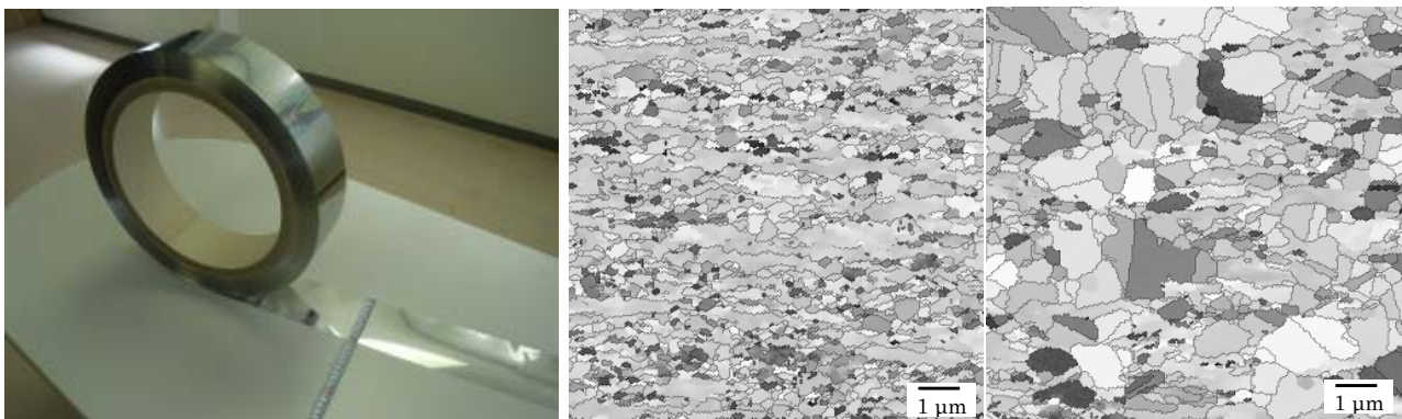
図 2-2-3. H20 年度研究で逆相変態を用いて試作した SUS304 超微細粒鋼 (左：試作したコイル 中央：試作材 EBSD 組織(0.45 \mu m) 右：試作材 EBSD 組織(粒径 0.80 \mu m))
