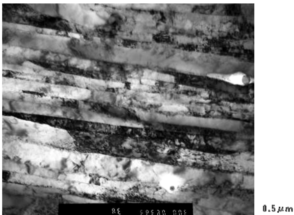
図 2-1-8 線材の TEM による微細組織観察（明視野像）
