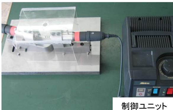
図 32 耐久性加速試験機外観写真
