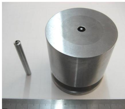
図 12 圧粉体成形用金型外観写真
