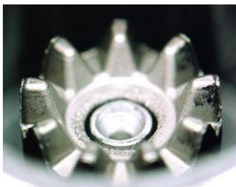
図 10 実機耐久試験後のギヤ製品外観
