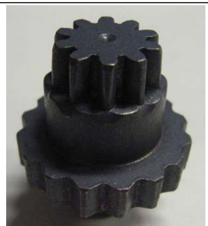
写真-1 ダブルギアの鍛造成形
