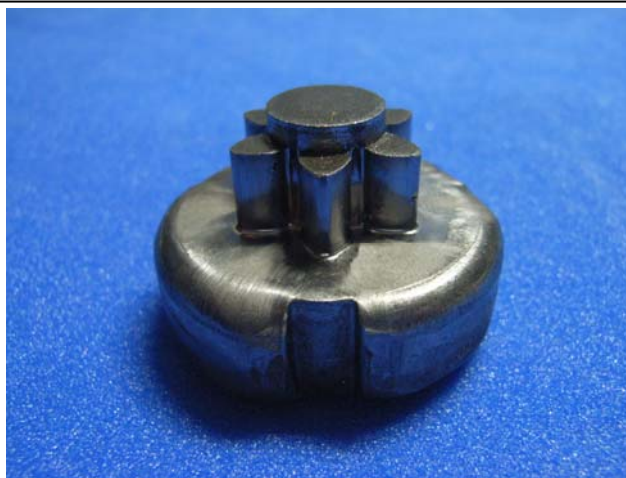
写真－３ 鍛造後の形状
