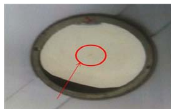
ダメージ発生(レーザー入射面) 金属コーティングにクラック発生
