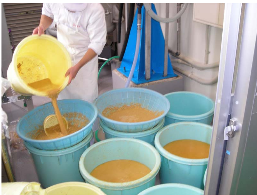
写真 自然ろ過による固液分離作業
