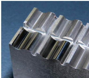
図23 オリジナル工具による3D 鏡面切削品(左)と拡大観察面(右)
