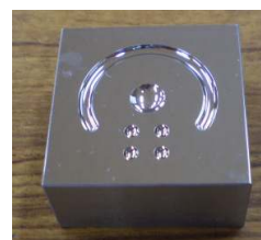
図3 ワンマシン完結型プロセス で製作した金型入れ子
