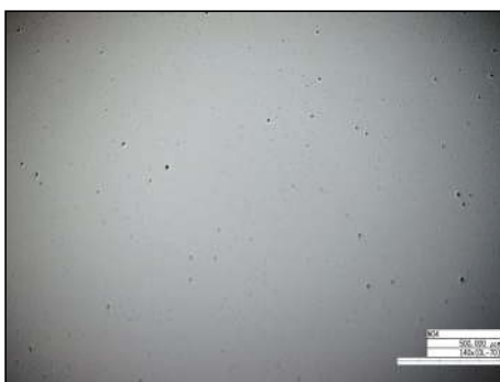
a) 仕上げ面に点状欠陥が残る未完成工法
