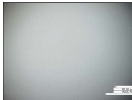
b) 最適仕上げプロセスによる仕上げ面 ( Rz_{jis} = 28nm , R_{max} = 49nm )
