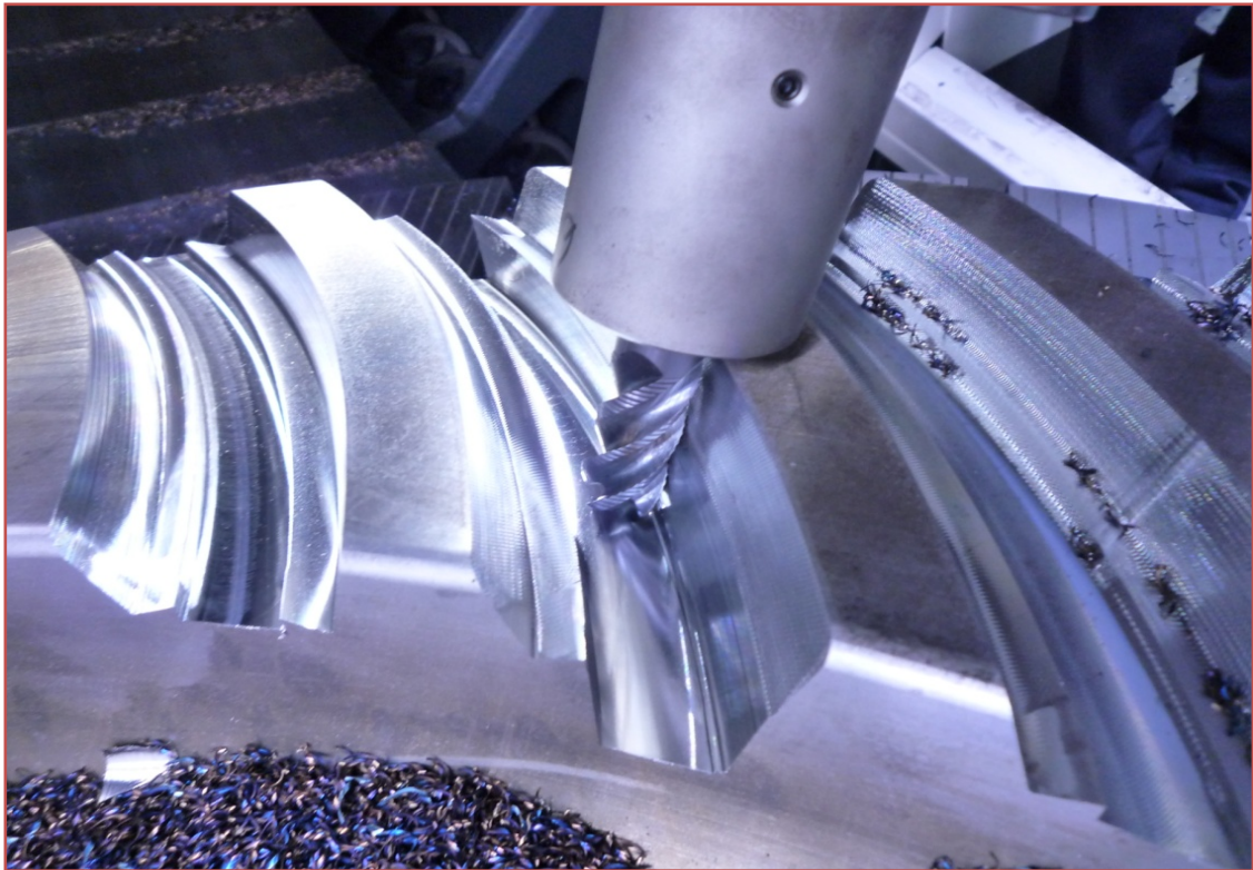
図-10 \phi 20 ラフィングエンドミルによるギヤ荒歯切り加工
