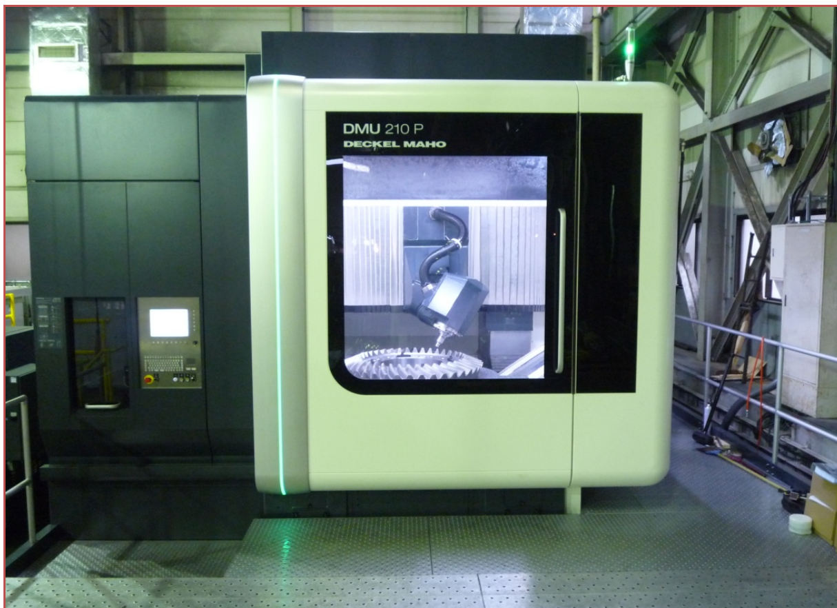
図-9 同時5軸制御マシニングセンター(ドイツDMG社; DMU210P)
