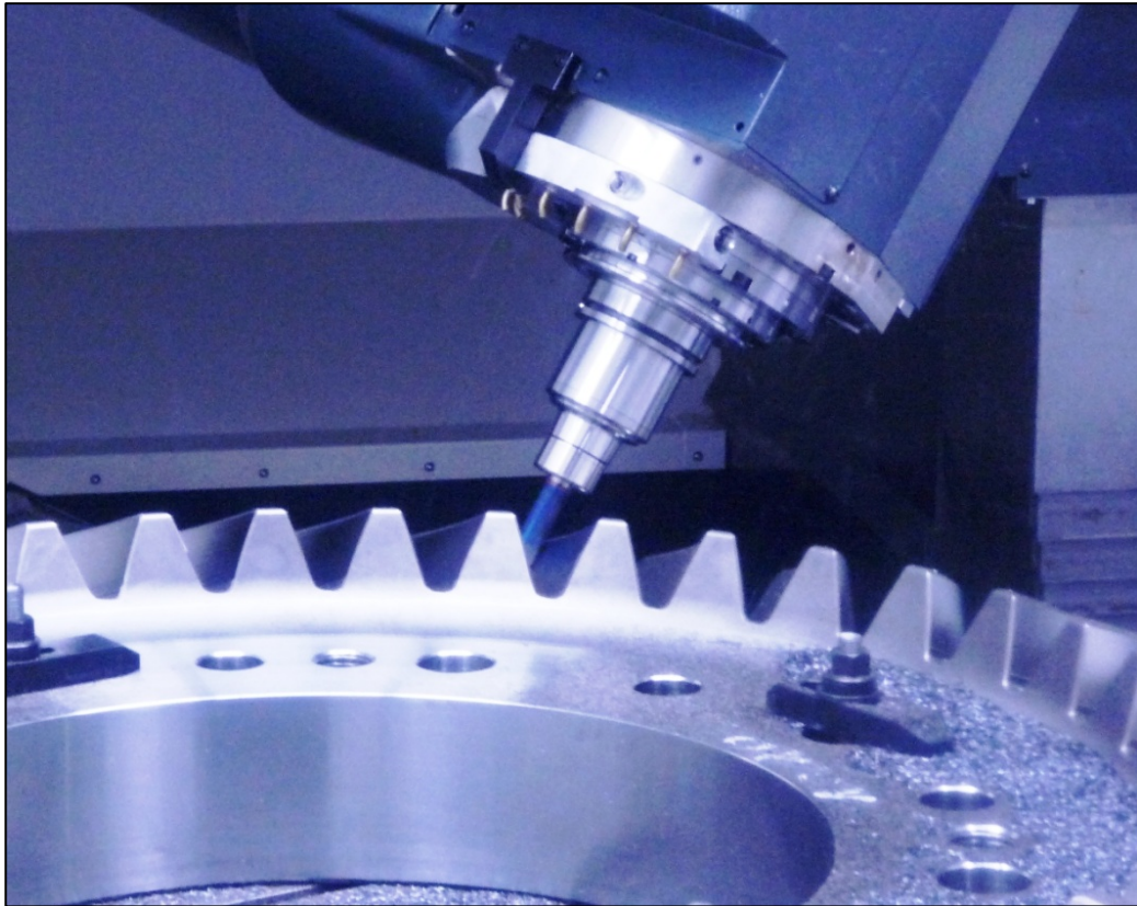
図-13 \phi 20 、12枚刃エンドミルによるギヤ仕上げ歯切り加工(スワーフ加工)
