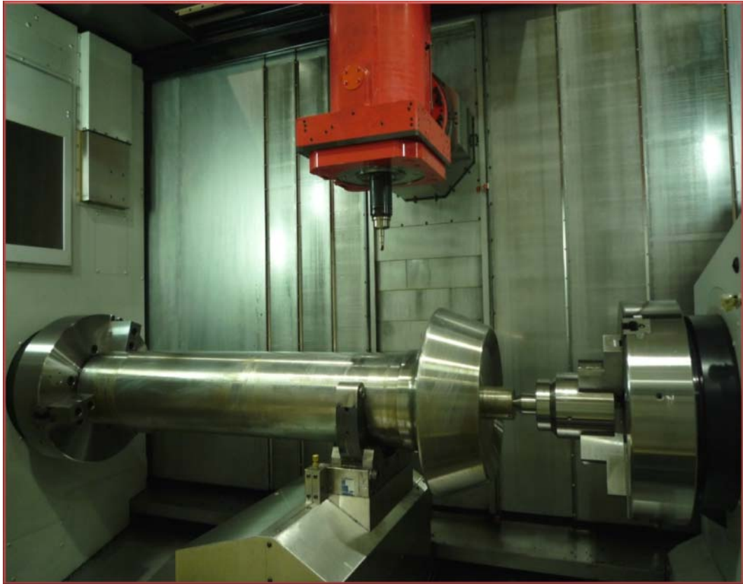
図-17 同時5軸制御複合加工機(森精機; NT6600)による荒歯切り加工
