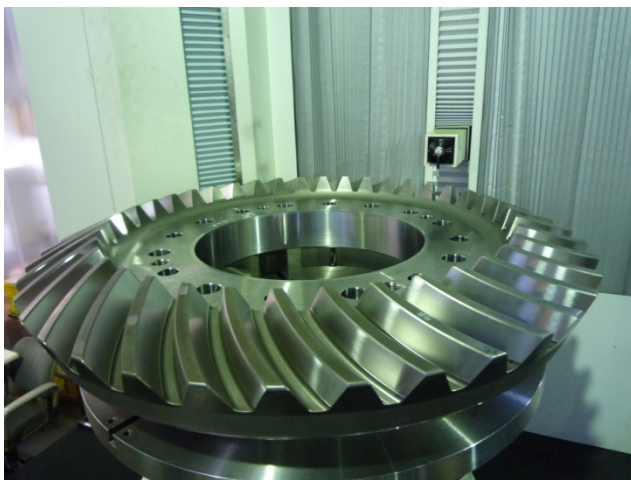
図-14 三次元歯車測定機を用いたギヤの歯車精度検査状況
