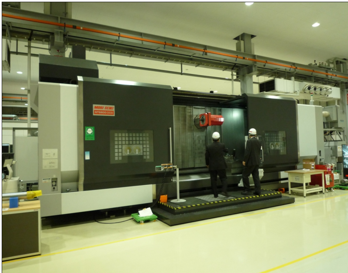
図-16 同時5軸制御複合加工機(森精機; NT6600)
