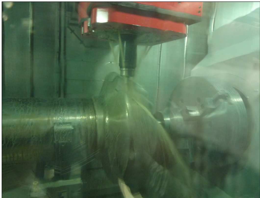
図-18 同時5軸制御複合加工機(森精機; NT6600)による荒歯切り加工
