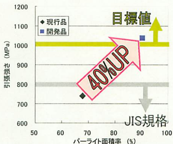
図3 パーライト面積率と引張強さの関係
