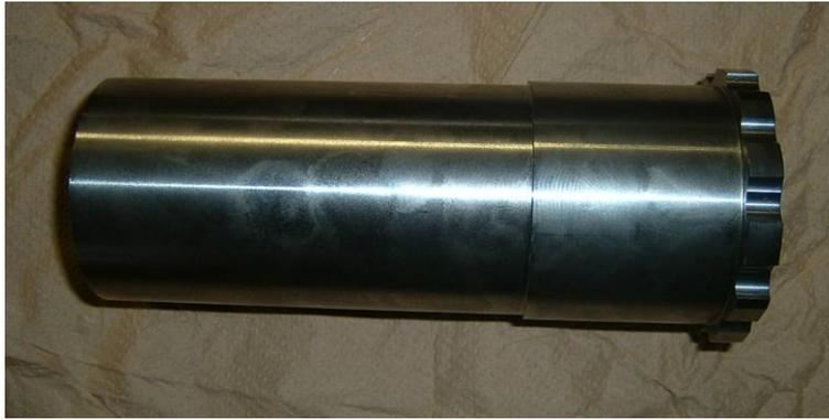
図 5-2-2-3 アルミニウムダイキャスト成形用金型部品（コア）
