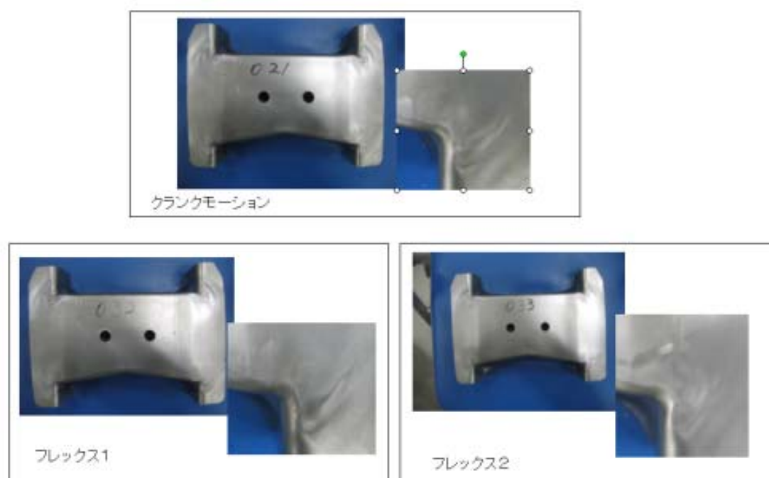
図6-21 実験2の成形品のしわの状態
