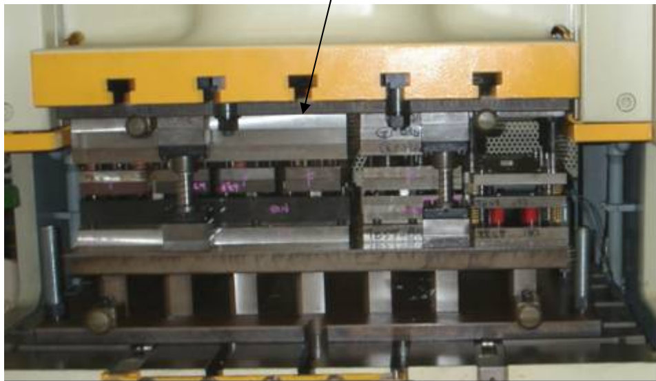
図6－2 ドアチェックケース金型およびその製品
