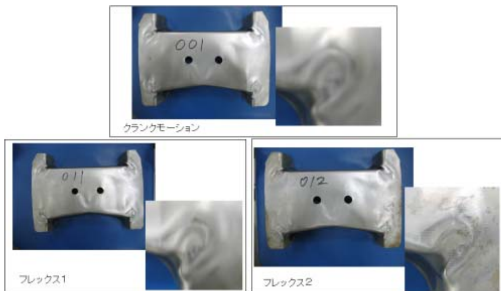
図6－19 実験1の成形品のしわの状態
