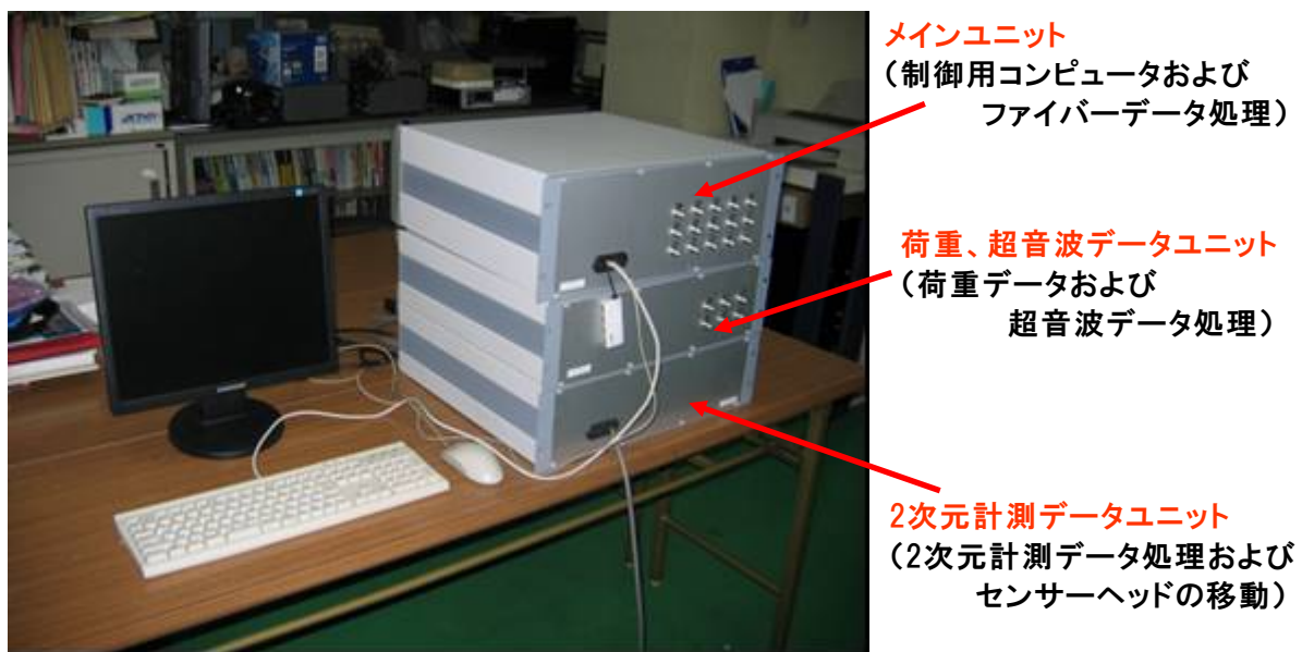
図 4 - 2 センシング制御装置
