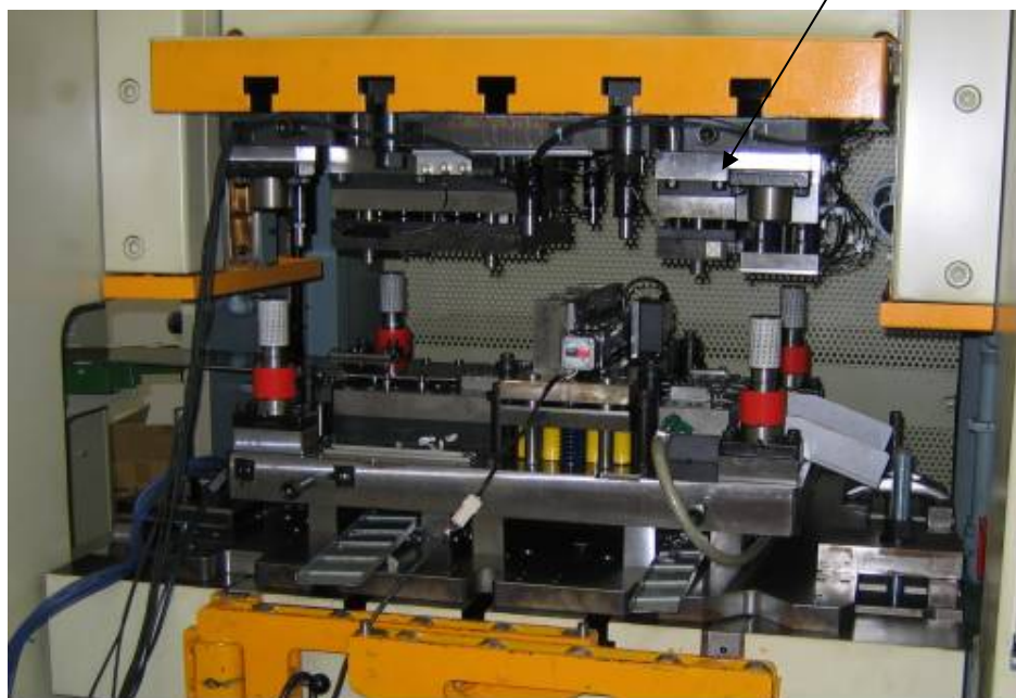
図6-1 ドアチェックレバー金型およびその製品
