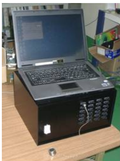
図3-8 荷重センサーテスト用のセンシング制御装置
