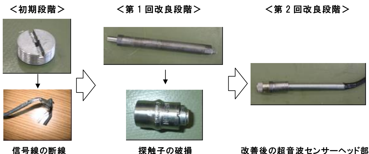
図3-10 超音波センサーユニット改良の変遷
