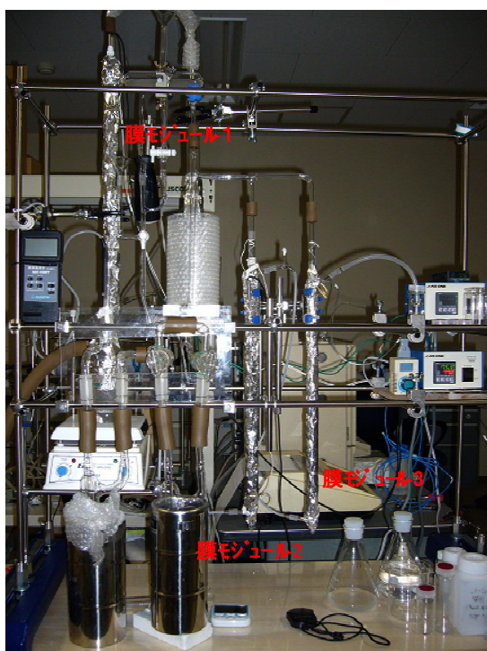
(a) 使用した膜分離システム
