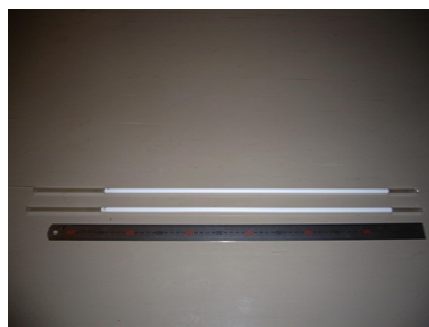
(b) 作成したセラミック分離膜(長さ50 cm, 外径 1 cm)
