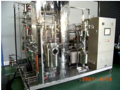
開発した固体培養実証プラント
