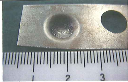
図 4-2-1-10 新構造パンチでプレスした鋼板
