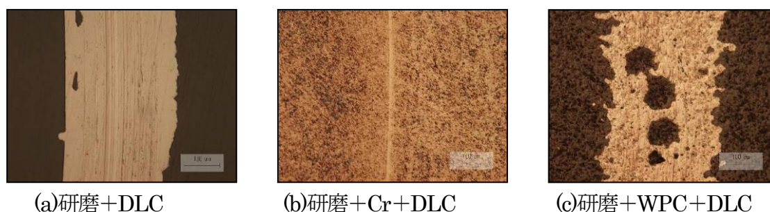
図 2.4 Ball on disk 試験後の Disk 摺動面
