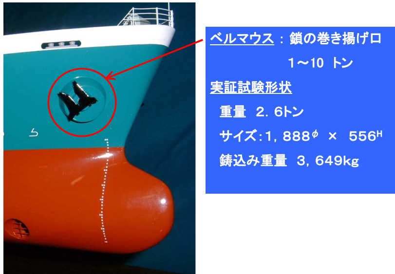
図2-2-1 実証試験に用いたベルマウス形状
