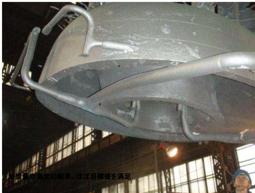
図2-2-2 2.6トンのベルマウス形状での実証試験結果
