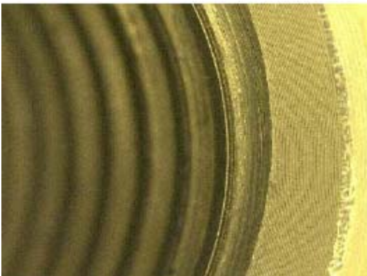
Fig.4-1-3-7 TR22 タップ加工ナット x 30 倍 Fig.4-1-3-8 TR22 タップ加工ナット x 100 倍
