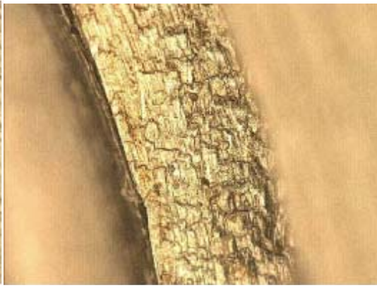
Fig.4-1-3-5 TR22 旋削加工ナット x 30 倍 Fig.4-1-3-6 TR22 旋削加工ナット x 100 倍
