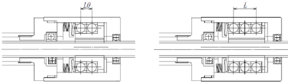
Fig4-1-4-1 自動変速機構部内部構造 (左：変更前 右：変更後)
