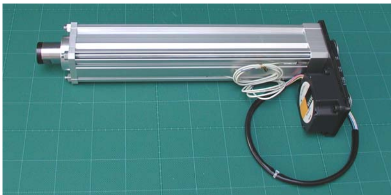
Fig.5.3.5.1 谷底径 \phi 11.4 mm の転造ネジが組み込まれた 3 kN 用リニア駆動ユニット
